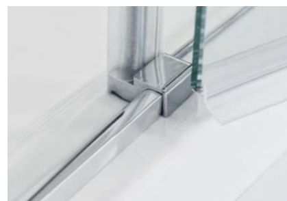
■ A záróelemek és az alsó szilikonok tökéletes vízzárást biztosítanak
